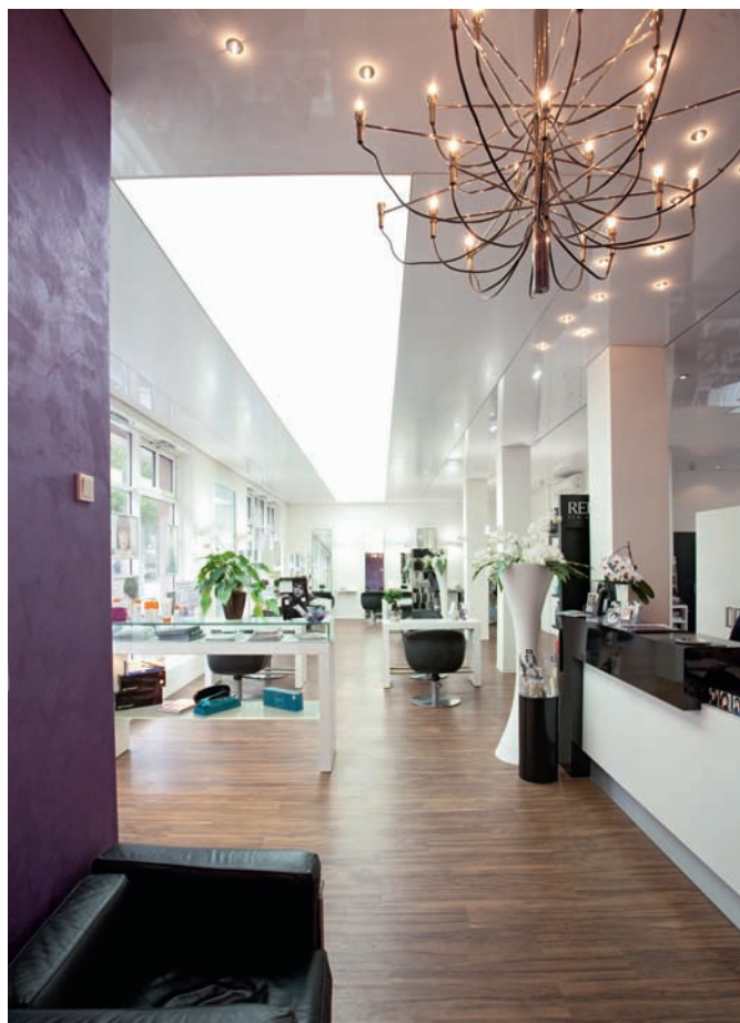
Friseursalon Lieb in St. Ingbert mit hochglänzender Spanndecke mit Swarovski-Kristallen im Eingangsbereich und einem Lichtdeckenfeld für schatten- und blendfreies Licht an den Arbeitsplätzen. Hier wurden zusätzlich Deckenheizungspaneile integriert. Die Wand wurde mit einer brombeerfarbenen Perlmutter-Spachteltechnik versehen.
